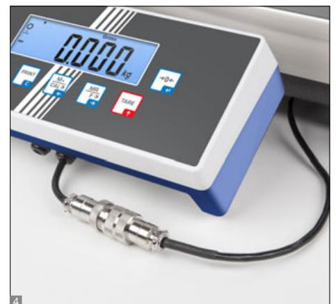
4 Eichstecker, ermöglicht bei geeichten Waagen das Trennen von Auswertegerät und Plattform ohne die Eichung zu zerstören, z. B. für einen nachträglichen Einbau der Waage in einen Pack- und Versandtisch, Grubenrahmen etc.
